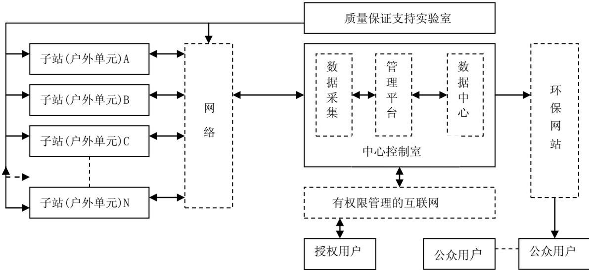
**图 1 环境噪声自动监测系统基本构成框图**
