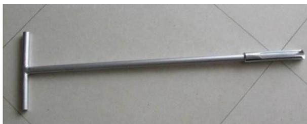
图 6-3 手工钻探设备（管钻）
