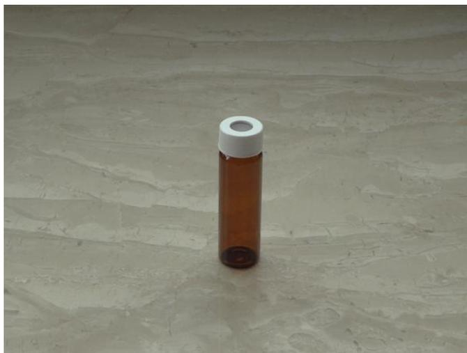
图 6-12 40ml 具聚四氟乙烯-硅胶衬垫螺旋盖的棕色玻璃瓶
