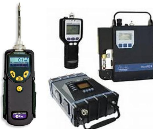
图 6-6 便携式有机物快速测定仪
